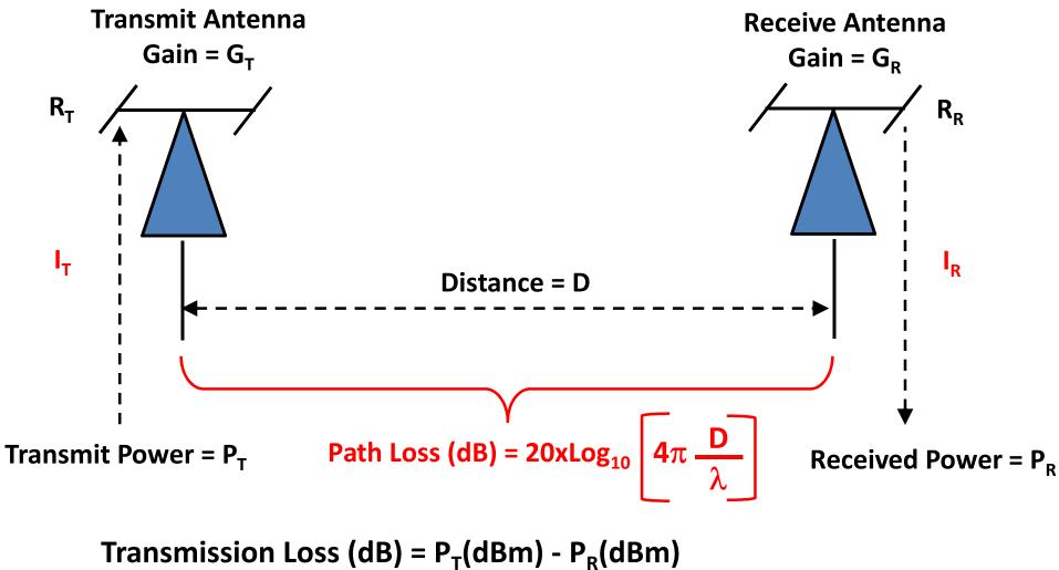
= Path Loss (dB) - G<sub>T</sub>(dBi) - G<sub>R</sub>(dBi)
